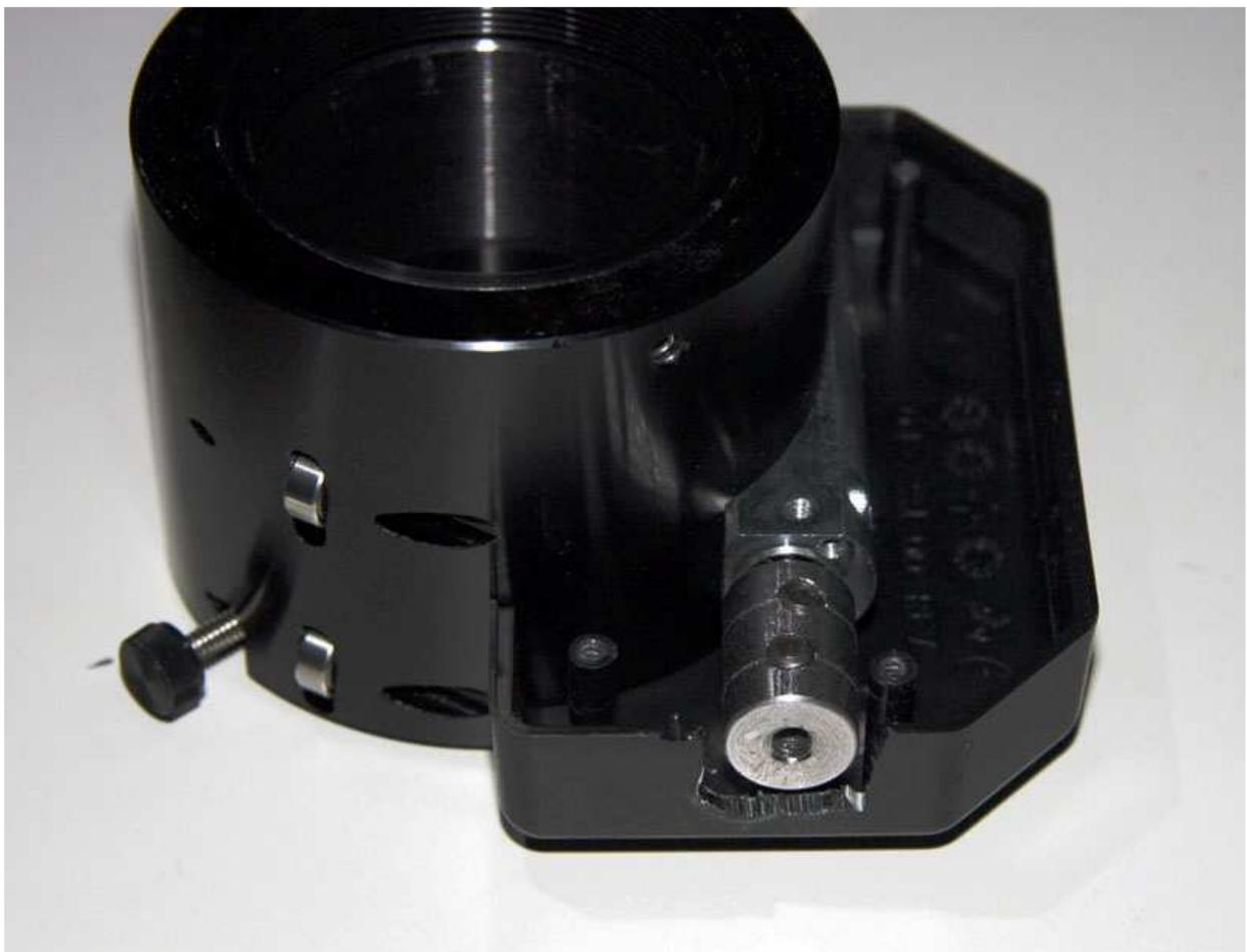
**7º-** Para la unión de ambos ejes utilizaremos un canutillo de aluminio con 2 prisioneros, uno a cada lado. Con esto lo que conseguimos es el poder sustituir fácilmente y en cualquier momento el motor en caso de fallo.
