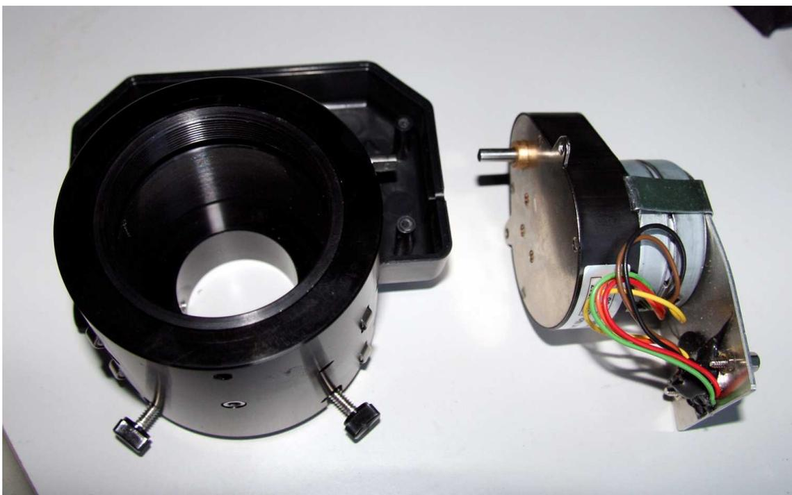
6º- Para poder encajar los dos ejes deberemos de abrir un agujero en la carcasa del microenfocador para poder introducir el eje del motor. Para ello hemos utilizado un viejo estañador, quemando la carcasa de plástico hasta obtener el orificio del tamaño deseado.
